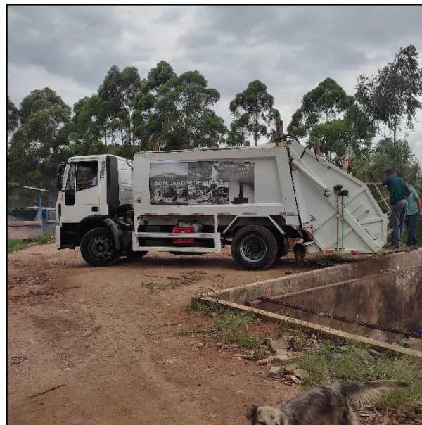
Figura 72 – Exemplo de caminhão coletor utilizado para a caracterização física dos resíduos sólidos.
